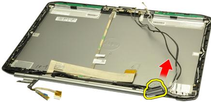
17. Снимите крышку левого шарнира дисплея.
