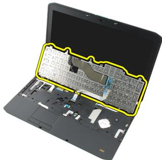
10. Отсоедините кабель передачи данных клавиатуры и снимите ее с компьютера.
