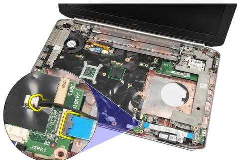
11. Выверните винт, которым звуковая плата крепится к корпусу компьютера.
