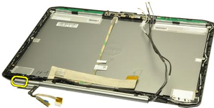
18. Снимите опору левого шарнира дисплея.
