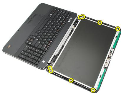
5. Переверните панель дисплея и отсоедините кабель дифференциальной сигнализации низкого напряжения (LVDS).
