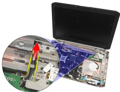
15. Выверните винты, которыми дисплей в сборе крепится к корпусу компьютера.
