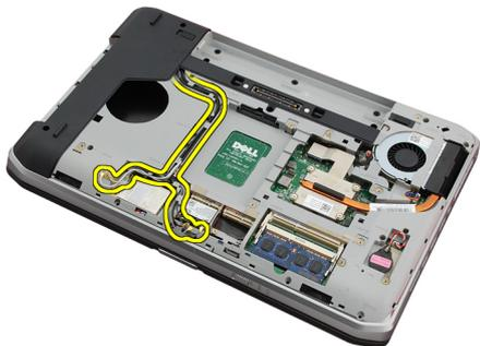
12. Отсоедините кабель дифференциальной сигнализации низкого напряжения (LVDS).
