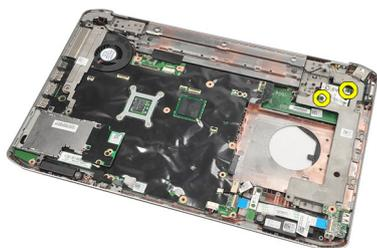
13. Приподнимите плату модема, чтобы высвободить из разъема на задней части платы, и извлеките ее из компьютера.
