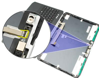
6. Ослабьте винт, которым крепится камера и модуль микрофона.
