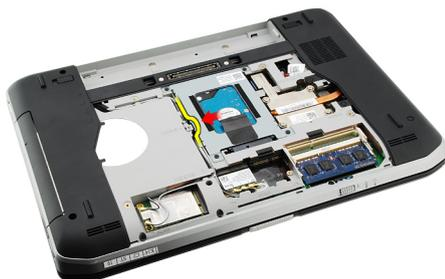
6. Извлеките оптический дисковод из компьютера.
