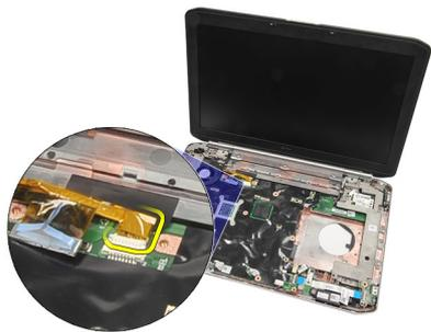
14. Протяните антенные кабели через отверстие в верхней части компьютера.
