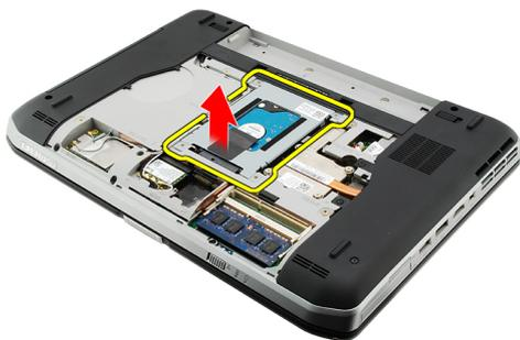
6. Выверните винты каркаса жесткого диска.
