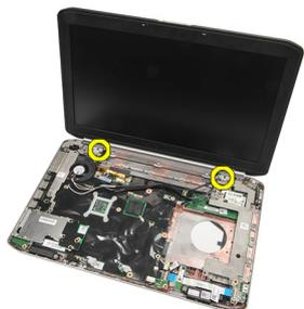
16. Снимите дисплей в сборе.
