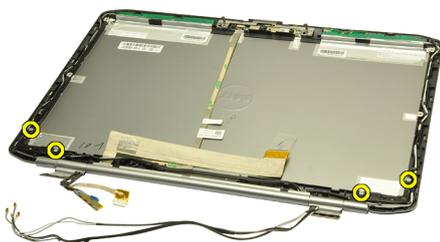
13. Снимите крышки шарниров дисплея.
