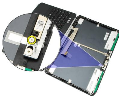
7. Приподнимите и извлеките модуль камеры.
