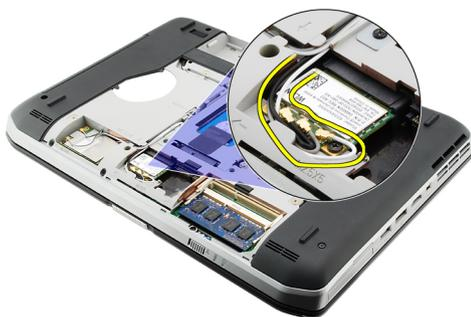
5. Выверните винт, которым плата WLAN крепится к системной плате.
