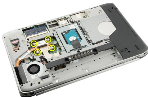
6. Приподнимите радиатор и извлеките его из компьютера.
