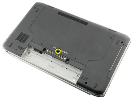
5. Переверните компьютер и выверните винты, которыми клавиатура крепится к передней части компьютера.
