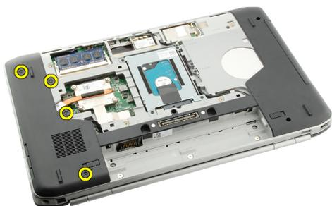
5. Снимите крышку центрального процессора.
